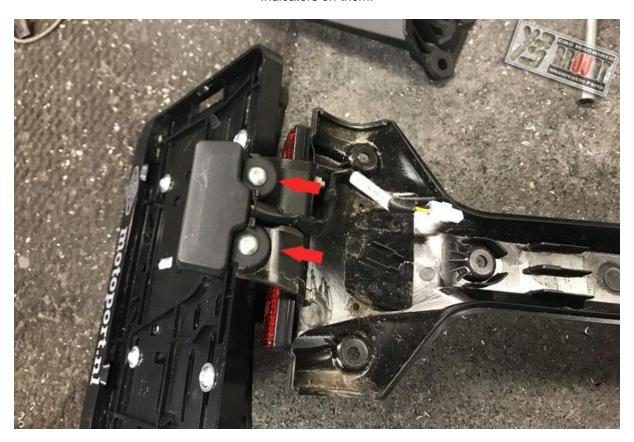
Wenn sie die Original Blinker behalten möchte ist es jetzt Zeit um die Blinker auf der Kennzeichenhalter zu montieren. Achten Sie, dass es eine Linke und Rechte Blinker gibt. (SX ist Links. DX ist Rechts)
