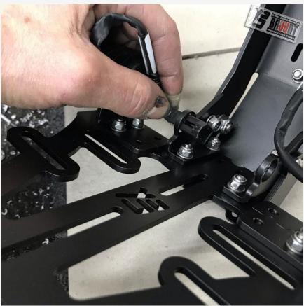
Schritt 7: Montieren Sie die Kennzeichenbeleuchtung. Nutzen Sie dafür beide mitgelieferte M4
