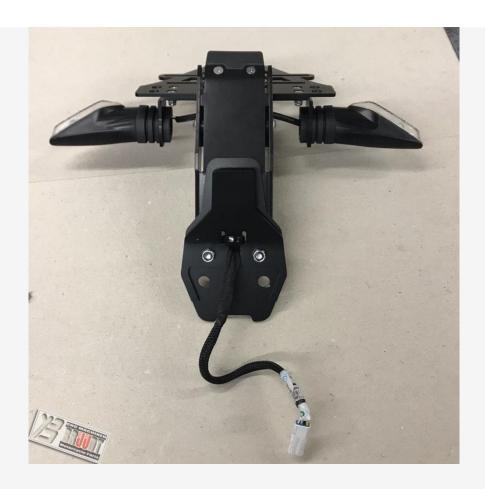
Schritt 8:. Nutzen Sie ein Bisschen fett oder ähnliches beim roten Pfeil so dass das es besser in das Gummi schiebt bei montieren. Schließen Sie das Kabel wieder an. Drucken Sie der Kabel so weit wie möglich unter das Heck.
