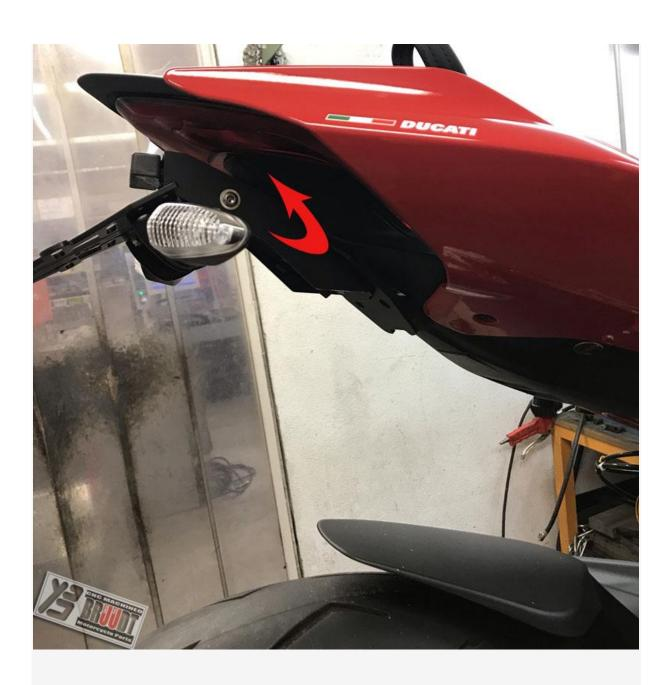
Schritt 8:. Nutzen Sie beide Original M5 schrauben mit die Schwarze scheiben um das Heck wieder zu montieren.
