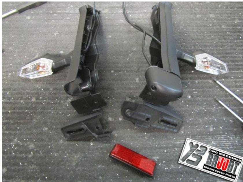
🇩🇪 Entfernen Sie die Kennzeichenbeleuchtung. Rechte Schraube erst. Dann schieben Sie die Beleuchtung einfach aus das Heck.
