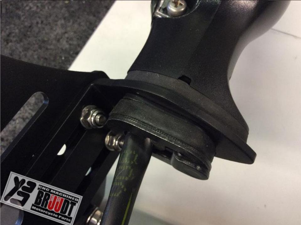
🇩🇪 Schritt 10: Montieren Sie der Kennzeichenbeleuchtung. Wie auf die nächste Bilder zu sehen ist.
