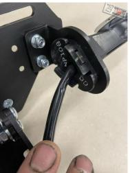
Wenn die Original Blinker wieder montiert sind Wackeln die noch. Dafür sind die Distanz Bleche mitgeliefert. Stecken sie die Distanz Bleche zwischen das Gummi und Blinker Halter.
